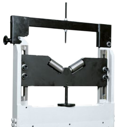
Equipaggi a V con rulli per l'equilibratura di alberi completi di cuscinetti. V carriage with rollers for balancing rotors with their own bearings.
