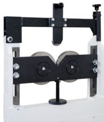
Equipaggi standard a rulli bombati. Standard crowned roller carriage.
