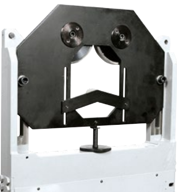
Equipaggi rovesciati per equilibrature a sbalzo. Reverse thrust carriage for overhung balancing.
