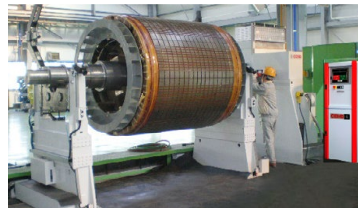
Esempio di equilibratura di grandi motori elettrici.
