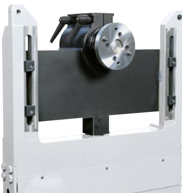
Equipaggi flangiati per equilibrare alberi di trasmissione. Flanged carriage for balancing drive shafts.
