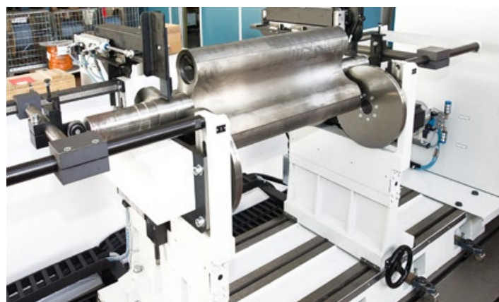
Equilibratrice orizzontale a supporti rigidi con trascinamento mediante rulli motorizzati.
