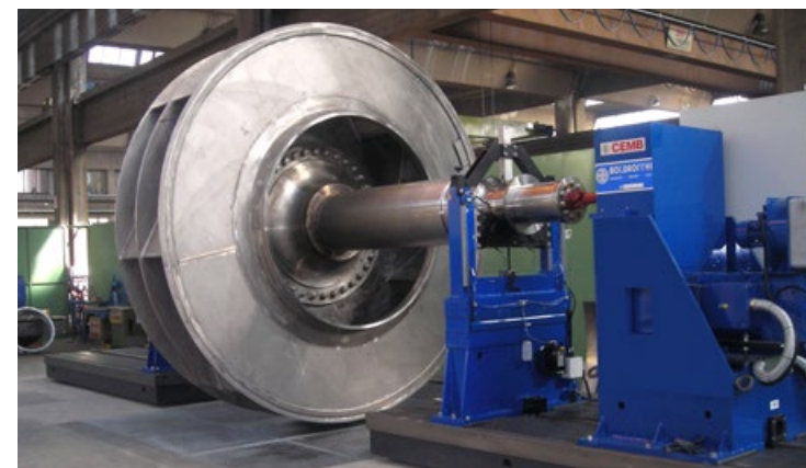
Equilibratrice orizzontale a misura di forze con supporti rigidi e taratura diretta in base alle dimensioni del rotante. Esempio di installazione con due bancali separati.
