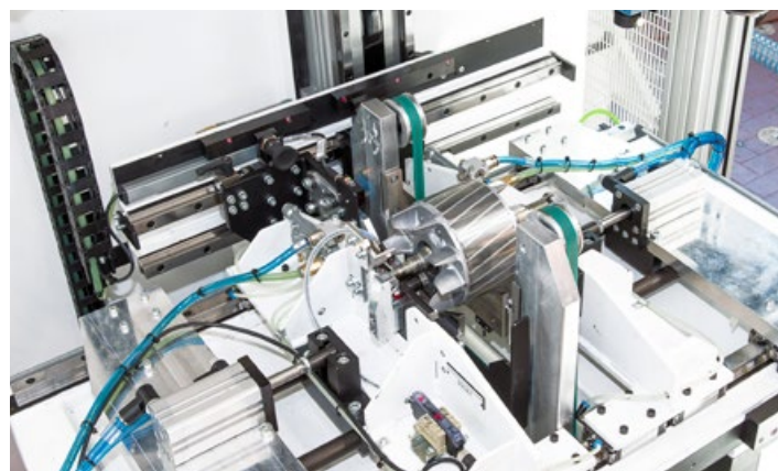
Equilibratrice automatica per rotor di motori elettrici. Correzione automatica su due piani per foratura radiale sui lamierini con sensore di posizione per evitare le barre di alluminio. Lift pneumatico per carico/scarico.
